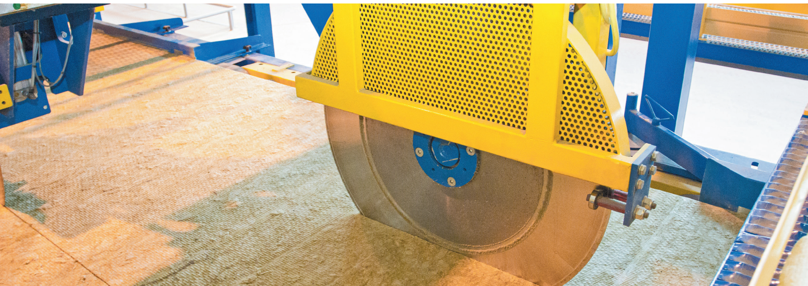
Завод теплоизоляционных материалов из минеральной ваты, участок распиловки
