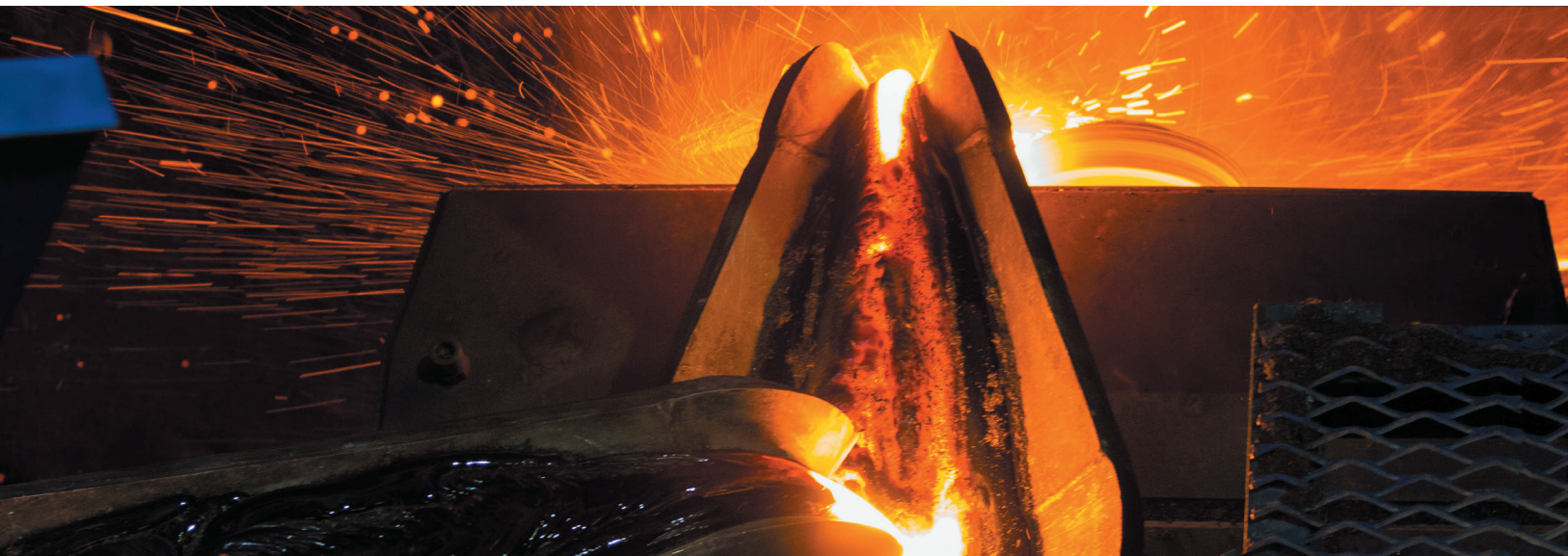
Завод теплоизоляционных материалов из минеральной ваты, участок подачи расплава на центрифугу
