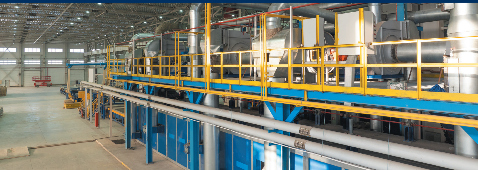
Завод теплоизоляционных материалов из минеральной ваты, камера полимеризации
